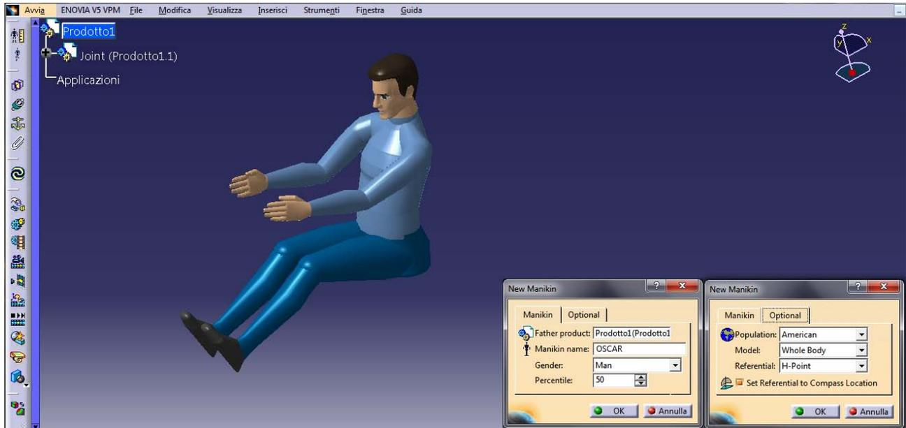
Tale posizionamento risulta di fatto determinante, da un punto di vista normativo, per il rispetto degli angoli di visibilità e fondamentale per garantire al conducente una buona abitabilità, garantire movimenti di routine e conferire sensazione di confort nell'abitacolo della vettura.
