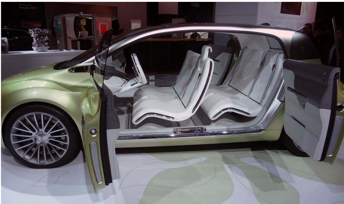
Se il passeggero esce con le portiere incernierate posteriormente aperte ed il veicolo è in movimento in avanti, viene urtato dalle stesse. Se le portiere incernierate posteriormente non sono perfettamente chiuse ed il veicolo è in movimento, si possono aprire a causa dell'aria che fluisce intorno alla vettura.
