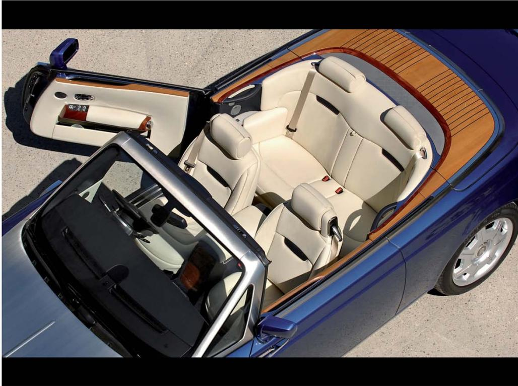
Le portiere posteriori montate convenzionalmente e le porte anteriori incernierate posteriormente rendono difficile la discesa dei passeggeri se aperte contemporaneamente, dato che sono montate entrambe sul montante centrale della vettura.
