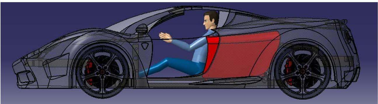
La luce d'ingresso non è ovviamente notevole ma comunque sufficiente a garantire l'accesso al veicolo di una persona standard che normalmente utilizza questo tipo di vettura.
